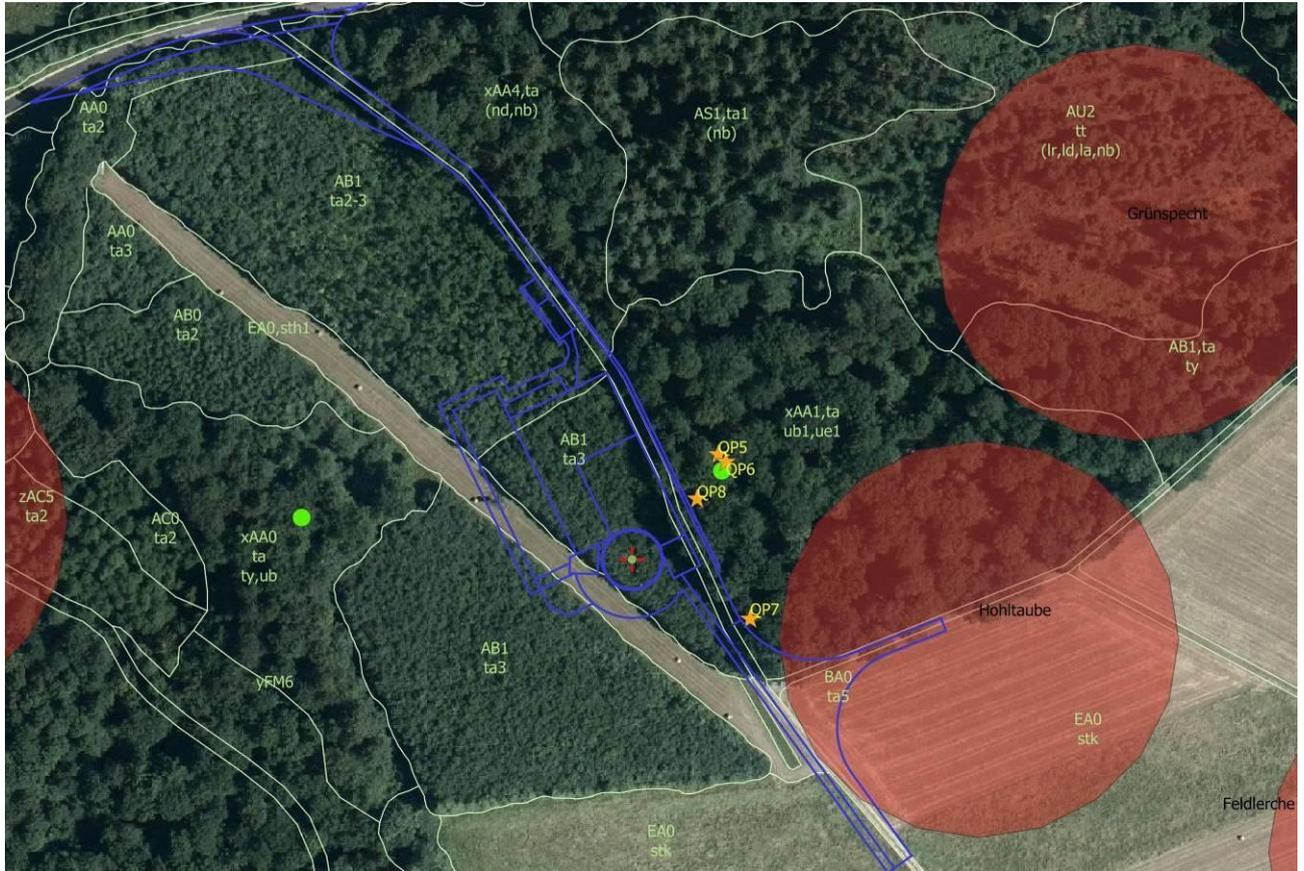
Abb. 18: Standort WEA 2 mit Bauflächen und Zuwegungen: dunkelrote Kreise = Revierzentren, hellgrüne Punkte = Vogelhorste, unbesetzt, Qp5 = Eiche mit Astabbruch (BHD = ca. 60 cm), Qp6 = Eiche mit mehreren Spalten und Spechtlöchern (BHD = ca. 50 cm), Qp7 = Buche mit Höhle (BHD = ca. 35 cm), Qp8 = Eiche mit Astloch (BHD = ca. 70 cm), vgl. Fotos 6 bis 9
