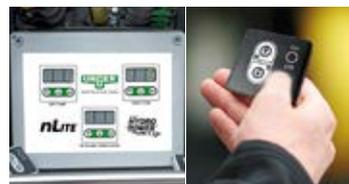
Die Menge der Wasserausgabe kann jederzeit am digitalen Bedienfeld eingestellt werden. Das spart Wasser, wenn weniger Druck benötigt wird. Sie können auch zwischen Wasch- und Spülmodus mit nur einem Knopfdruck an der Fernbedienung wechseln.
