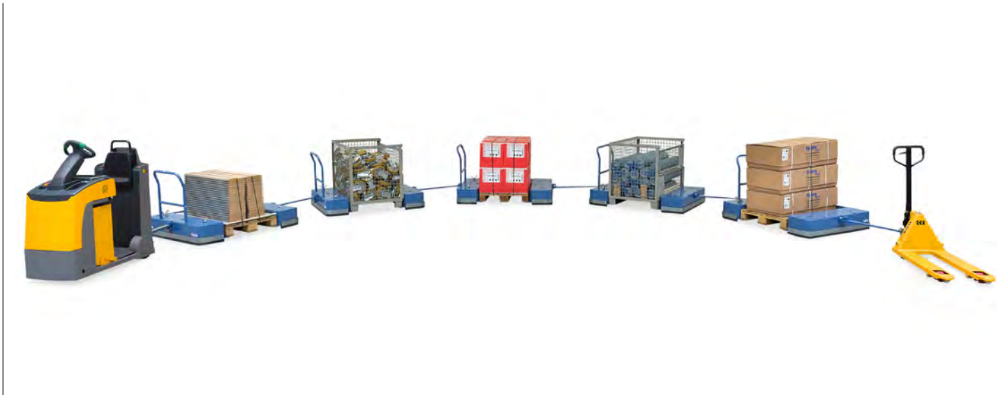
Routenzug mit Elektroschlepper und 5 Niederflur-Paletten-Fahrgestellen
