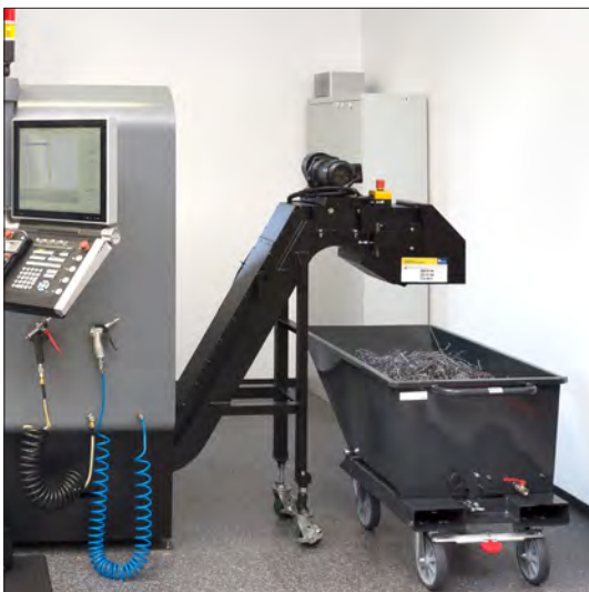
Anwendungsbeispiel: Muldenkipper als Spänebehälter
