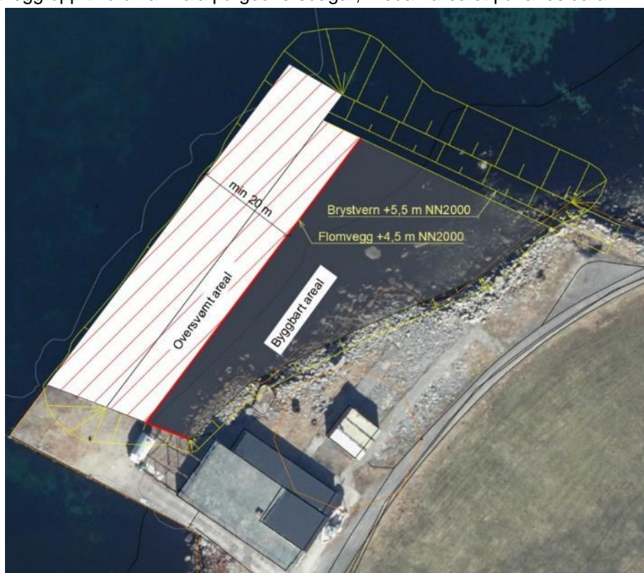
Figur 5-6: Mogleg løysing for sikring av næringsarealet med brystvern og flaumvegg, dersom molo 3 ikkje blir bygd.
