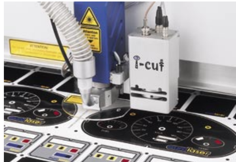
Sublimierschneiden: Der Laserstrahl verdampft und verbrennt das Material. Der Dampfdruck treibt die Schlacke aus der Schnittfuge.
