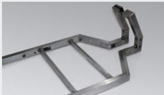
Intelligent: Die Knickkonstruktionen in diesem Rahmen eines Elektrofahrzeugs vereinfachen das Schweißen
