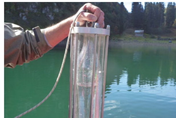
Bouteille intégrative permettant de prélever l'eau des lacs sur l'ensemble de la colonne d'eau
