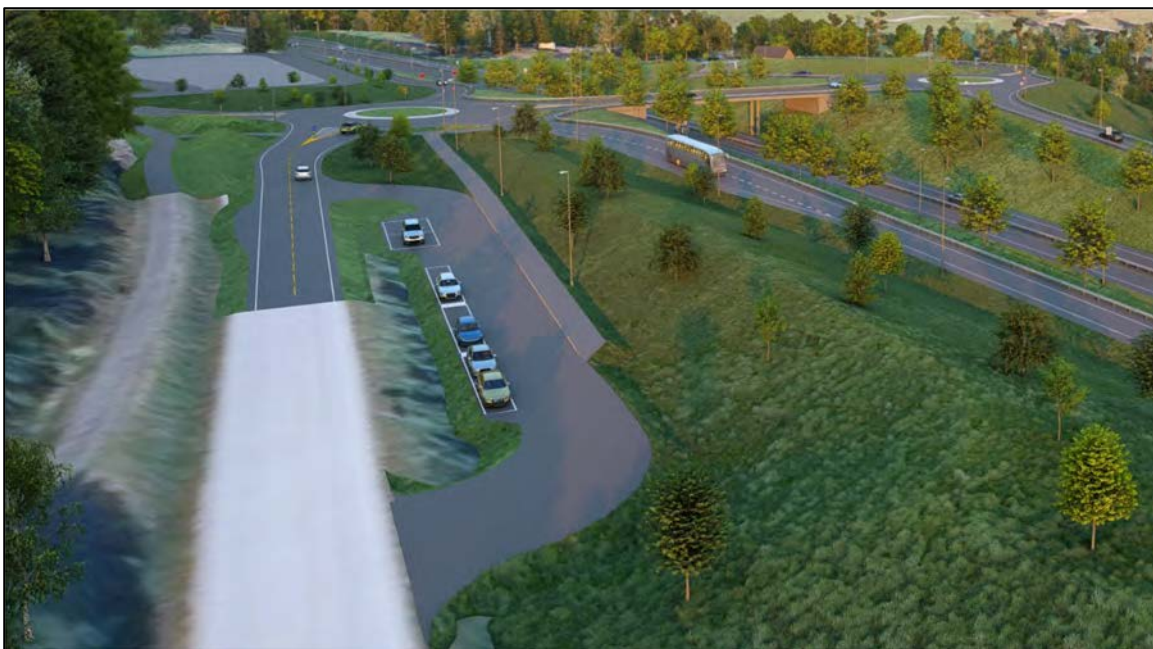
Figur 3–11: Einssidig busslomme ved rundkøyringsarm for fv. 57 mot Dale (Ill.: Multiconsult / Statens vegvesen).
