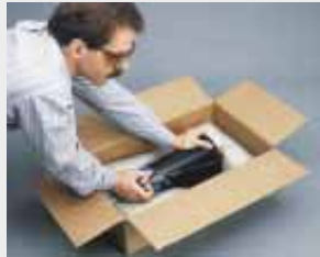
2. Die Instamate®-Folie wird über dem Schaum zusammengefaltet und das Produkt auf dem sich ausdehnenden Schaum polstert.
