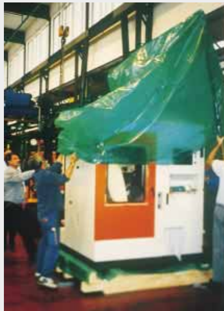
Exportverpackung einer Funkenerodiermaschine mit VCI-Schaum als Trägermaterial, für den Korrosionsschutz von innen und PE-Haube mit VCI (B+C)
