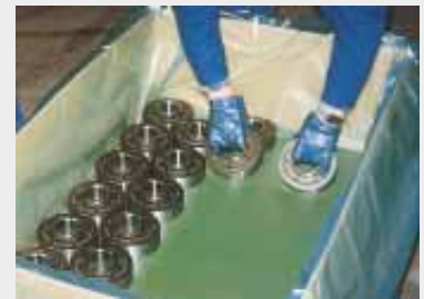
Exportkonservierung von fließgepressten Teilen mit PE-Haube aus VCI, in einer Holzbox. Wellpappzuschnitte, 2-seitig mit VCI ausgerüstet, zum Schutz am Boden und als Zwischenlagen (nicht abgebildet) (B+D)
