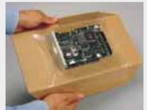
Durch das Herunterfalten der Spannflügel wird die Folie über dem Produkt gespannt und fixiert es somit.
