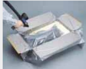
3. Ein 2. Stück Instamate®-Folie wird über das Produkt gelegt und wieder wird Instapak®-Schaum darüber verteilt.
