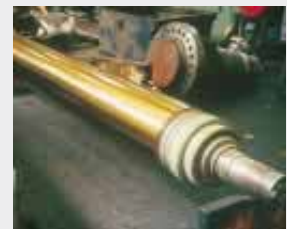
Hartgußwalze mit VCI-Konzentrat beschichtet, als grifffester Film für höchste Beanspruchung bei Freiwitterung und Salzwasseratmosphäre (E)
