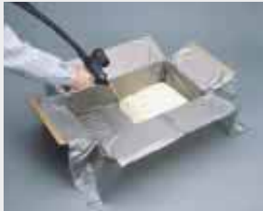
1. Instapak® wird in einen Karton gefüllt, der mit extrem reißfester Instamate®-Folie ausgelegt ist.
