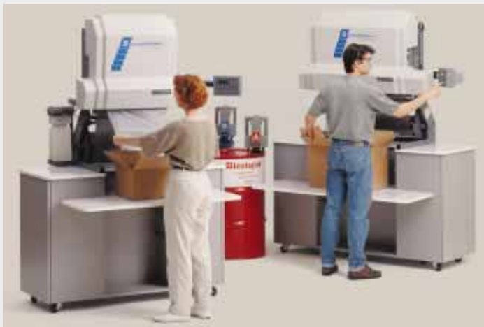
1. Mit einem Knopfdruck wählt der Bediener die richtige Beutellänge und die richtige Menge Instapak®-Schaum aus.
