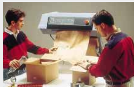
Die PaperBoy™ Packstation (Art. 504001) ist das Ständersystem mit Materialkonsole für kleine Papierrollen. Diese Version eignet sich aufgrund des geringen Platzbedarfs besonders für beengte Verpackungsbereiche.
