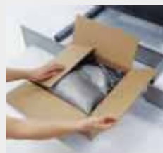
2. Der Bediener legt den mit Schaum gefüllten Beutel in den Karton und plaziert das Produkt auf das sich ausdehnende Kissen.
