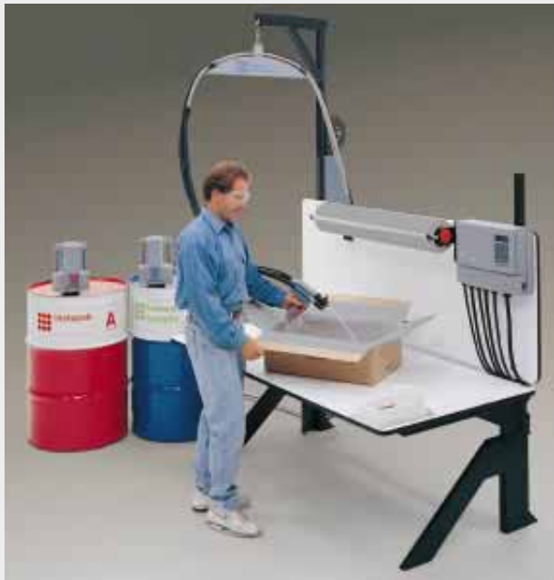
2. Die Instamate®-Folie wird über dem Schaum zusammengefaltet und das Produkt auf dem sich ausdehnenden Schaum polstert.
