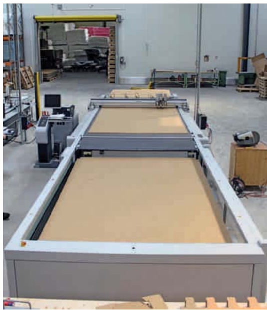
Automatisiertes Materialhandling – der Zünd Cutter G3 XL-3200 für Wellpappe wurde mit einem Board Handling System – BHS aufgerüstet.
