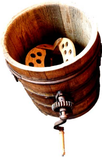
Abb.: Handbetriebe Buttermaschine, Blick auf die horizontale Welle mit Schlägern, Milch Museum, Willingen-Usseln/Hessen 16
