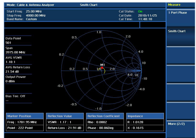
Prueba de cable y antena: carta de Smith
