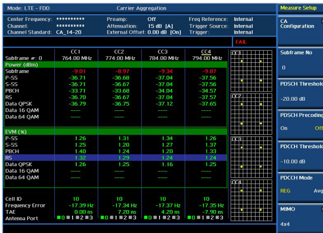
Análisis de modulación: acumulación de portadoras
