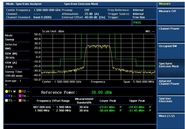
Análisis RF: máscara de emisión de espectro
