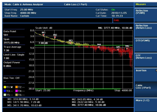
Prueba de cable y antena: pérdida en el cable
