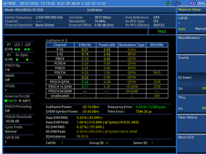
Ventana del analizador de señal RFOBSAI LTE-FDD
