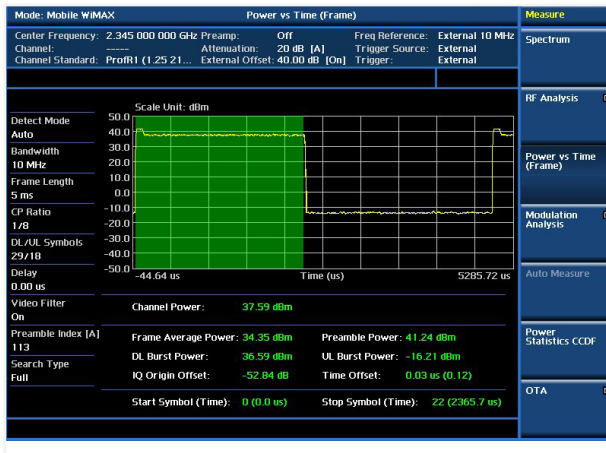
Análisis de modulación: potencia vs. tiempo
