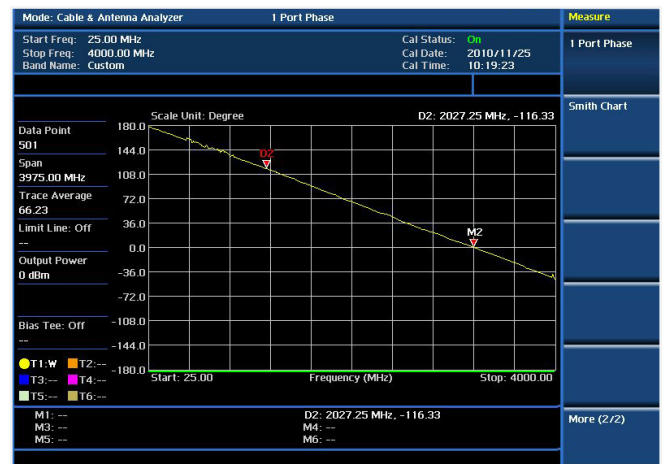
Prueba de cable y antena: fase - 1 puerto
