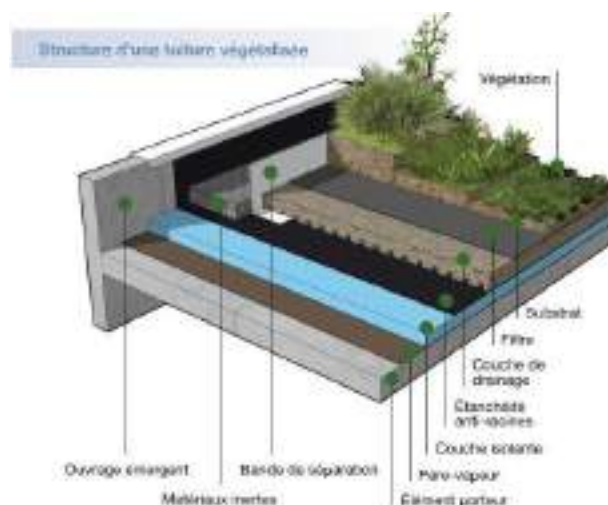
Figure 127: Structure d'une toiture végétalisée © LPO/CAUE Isère
