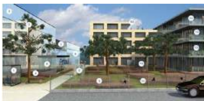
Vite d'analyse des dangers existant dans un bâtiment moderne : 1 son pour verre au maximum transparent 2 façades réfléchissantes (verre, métal, etc) 3 arbres devant une façade réfléchissante 4 sur-façade vertes attractives devant une façade réfléchissante 5 patio aménagé transparent 6 accès au garage avec patio vitré 7 passerelle transparente 8 façade réfléchissante 9 occupation air matériel réfléchissant ou transparent 10 angle transparent 11 accès d'hiver transparent 12 balustrade de balcon en verre 13 angle transparent 14 végétation derrière des surfaces transparentes 15 silhouettes de oiseaux très visibles.
