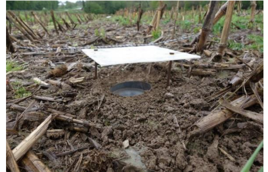
Piège au sol de type Barber
