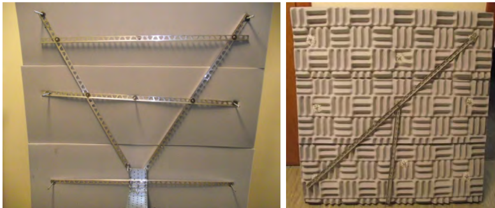
Abbildung 5: Inneres Aluminiumgerüst (links) und U-Profilstreben auf der Rückseite (rechts)
