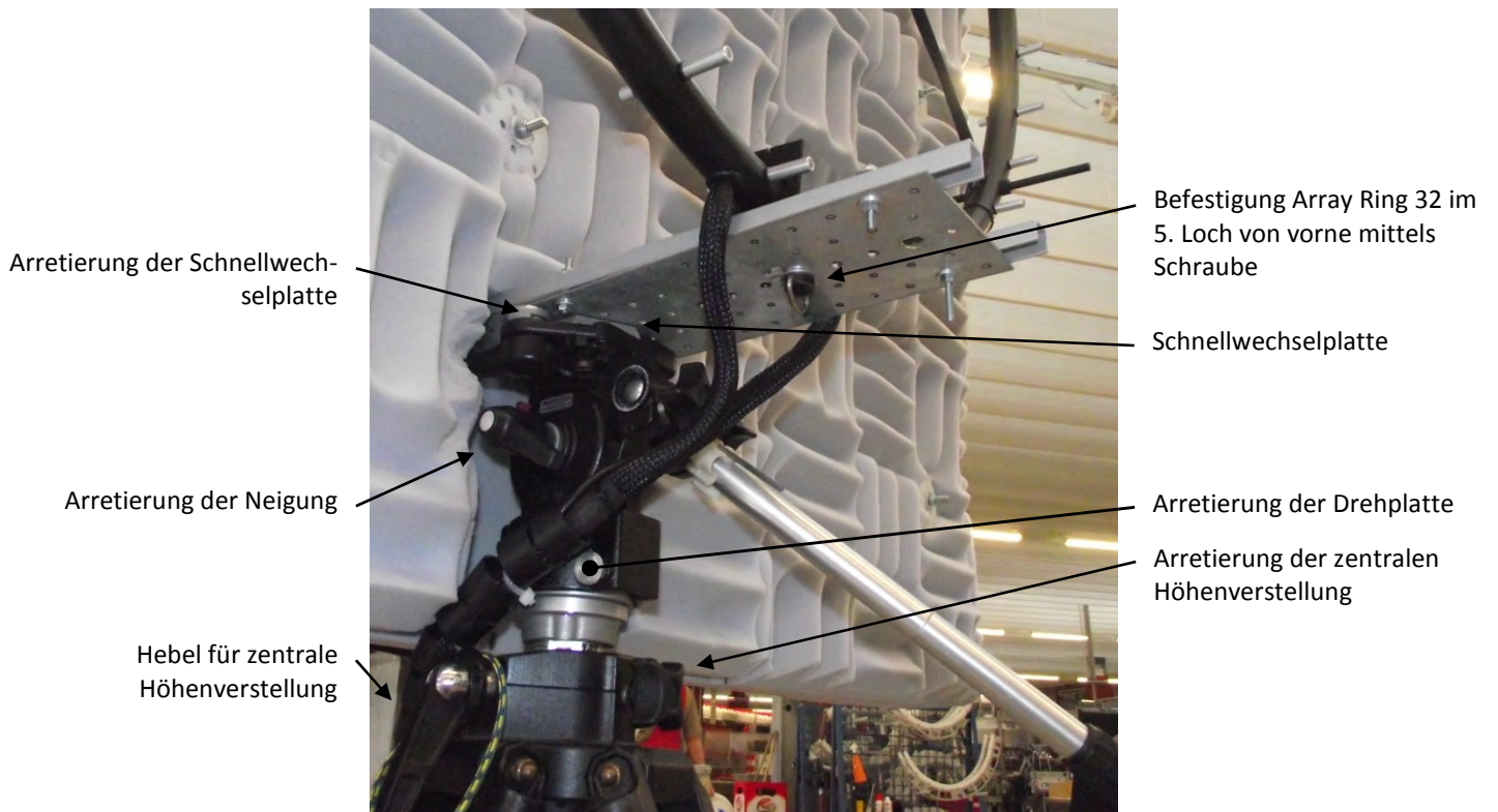
Abbildung 63: Messaufbau – Stativkopf
