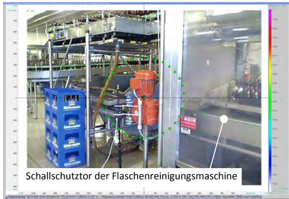
Abbildung 32: Getriebemotor der Flaschenzuführung zur Flaschenreinigungsmaschine
