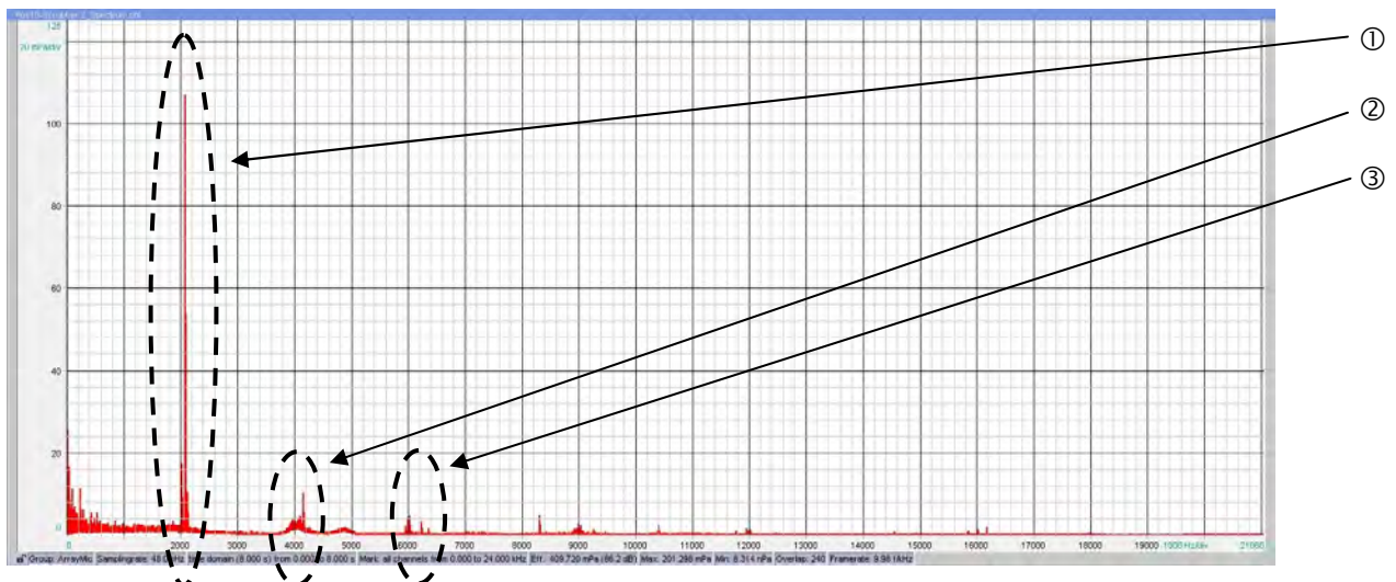
Abbildung 79: Spektrum der untersuchten Maschine in Abbildung 77 (x-Achse: Frequenz in Hz; y-Achse: Schallpegel in mPa)
