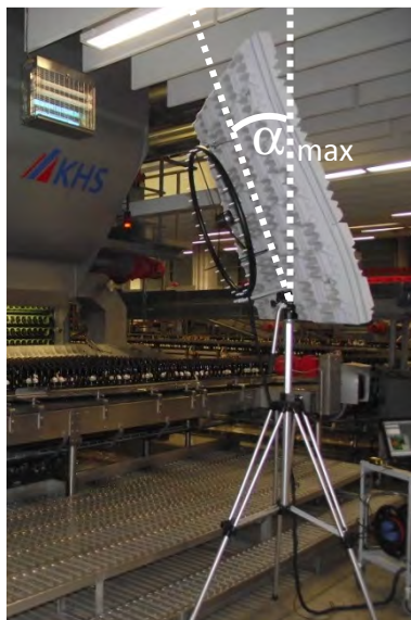
Abbildung 12: Maximaler vertikaler Kippwinkel \alpha_{\max} der Akustischen Kamera mit Abschirmung
