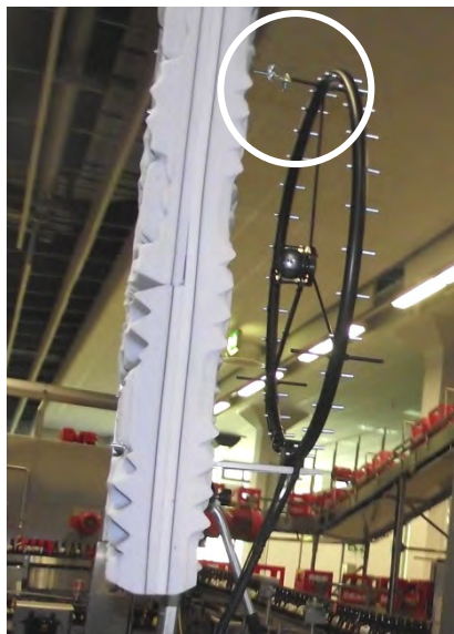
Abbildung 10: Steckverbindung zwischen Ring-Array und Abschirmung (Kreis)
