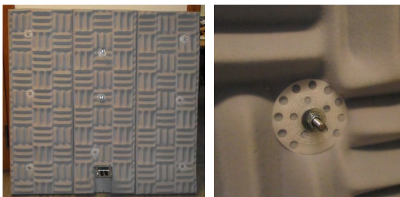
Abbildung 6: Vorderseite der akustischen Abschirmung (links) und Unterlegscheiben (rechts)
