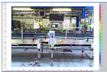
Abbildung 27: Versuchsaufbau mit Antrieb der Flaschentransportstrecke als Schallquelle
