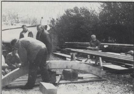
Boven: op de werf te Blankenberge wordt de voorsteven geschaafd. Op de achtergrond zien we hoe tekenaar Jan het gebeuren vastlegt.
