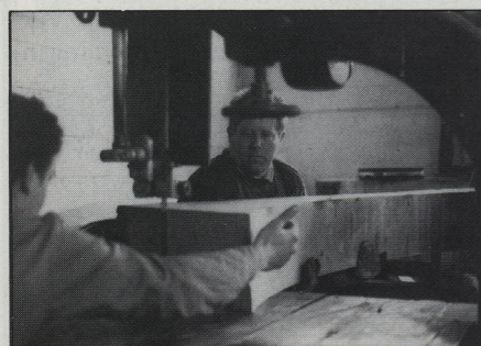
De voorsteven wordt uitgezaagd.
