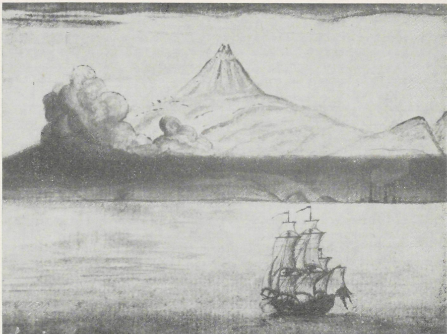
Fig. 4 : De Götha Leyon (1746-1749) (KB. C. J. GETHE. Dagbok hållen på Resan till Ostindien) voor Tennerife met ontplooiden zeilen. Men ziet o.a. de drijver achter aan de gaffel van de bezaansmast. Slechts één blinde staat gespannen, terwijl op beeld 3 twee blinders zichtbaar zijn.
