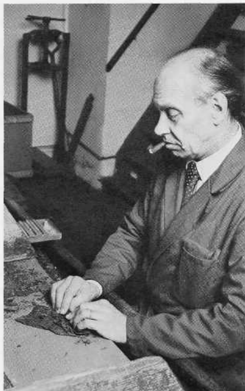
J. J. van der Donk bezig met het bosjesmaken: het omblad wordt om het binnengoed gewikkeld.
