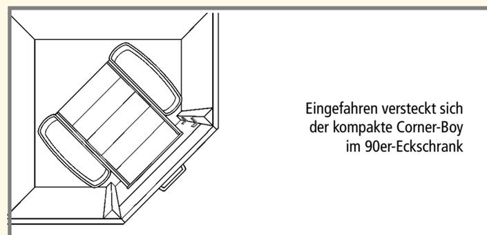
Der **Rollwagen DS** befördert den Abfallsammler bis hinten in die Ecke des Eckschranks und ermöglicht so eine optimale Ausnutzung des Schrankinnenraumes und leichten Zugriff auf alle Einsätze.
