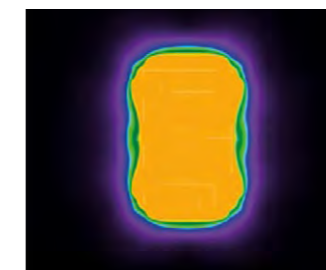
LO: Beleuchtung eines Sportplatzes mit Scheinwerfern mit Streulichtbegrenzung (LO)
