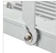
GentleSpace mit Montagebügel (BR): Zur einfachen Montage wird der verstellbare Montagebügel vorab an der Decke befestigt und die Leuchte anschließend eingehängt.
