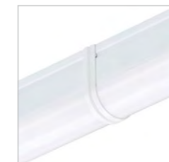
Die Ledinaire Lichtleiste hat einen integrierten Stecker und Buchse für eine starre Lichtbandverbindung.
