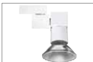
PAR30 - 230V, ø97mm, max. 100W Attacco E27
