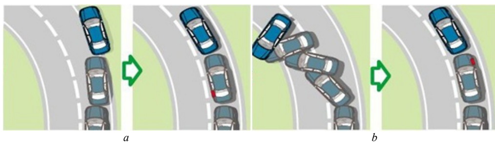
Obr.5: Vozidlo s nedotáčavým (a) a pretáčavým (b) šmykom.
