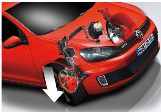
Obr.9: Schéma funkcie systému XDS v automobile.
