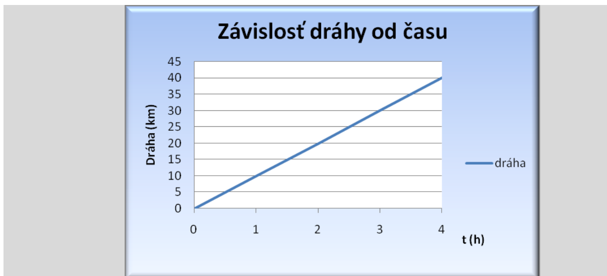
Obr. I.8: Závislosť dráhy od času pri rovnomernom priamočiarom pohybe
