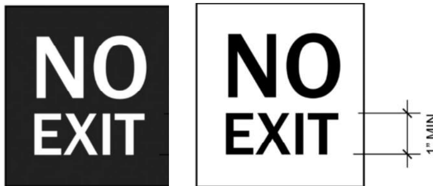
Abbildung 7: „NO EXIT“ Schild (kann als positiv oder negativ Bild hergestellt werden) (Quelle: [30])
