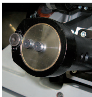
▲ Optional - außermittig verfahrbare Biegeköpfe erlauben den Einsatz unterschiedlichster Werkzeugkonzepte
