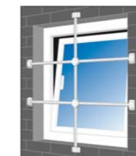
Montage auf der Fassade
