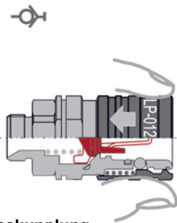
-0- Verschlusskupplung = Kupplung mit Ventil
