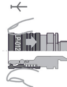
-4- Durchgangskupplung = Kupplung ohne Ventil
