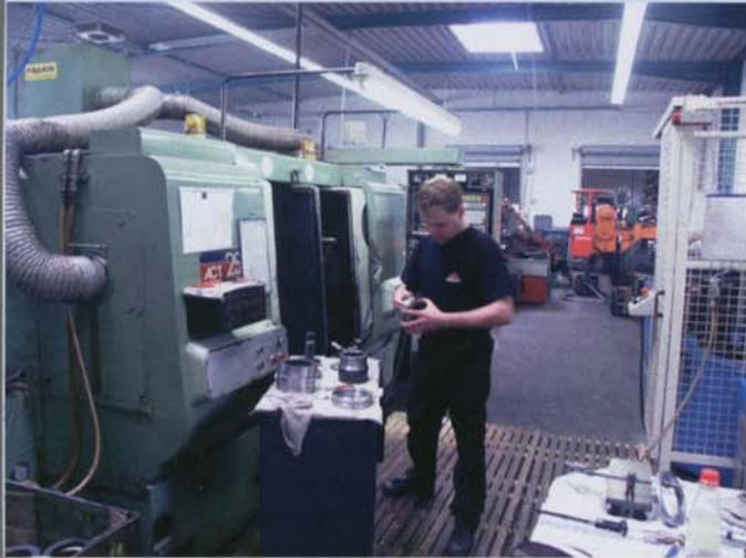
■ Dank überarbeitetem Werkzeugkonzept und optimierten Zerspanparametern prozesssicher: Trockenbearbeitung von Nutmuttern, C45 und St 52; Bild: SND, GFE
