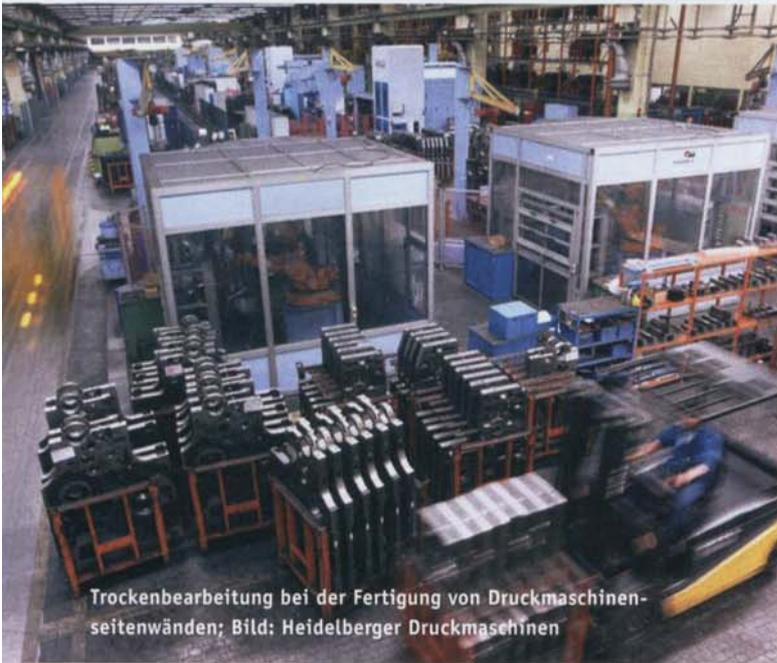
Trockenbearbeitung bei der Fertigung von Druckmaschinen-seitenwänden; Bild: Heidelberger Druckmaschinen
