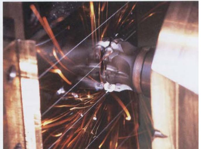
Feinschlichten mit beschichtetem Cermet: auch ohne Kühlschmierstoff sind hohe Schnittwerte möglich
