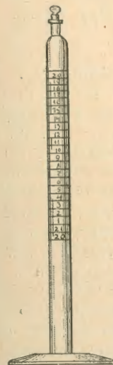
Obr. 198. Nádoba ke stanovení kyselin.
