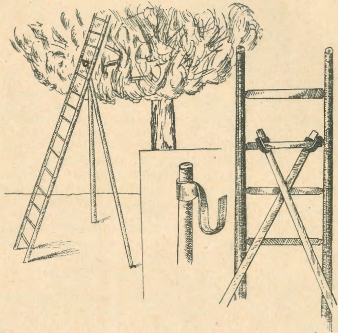
Obr. 54. Obyčejný žebřík upraven hákovými podpěrami, aby se při česání i při ořezávání stromu nemusil klásti na větvě.
