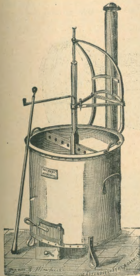
Obr. 169. Kotel k vaření povidel s vlastním topením a mísidlem.
