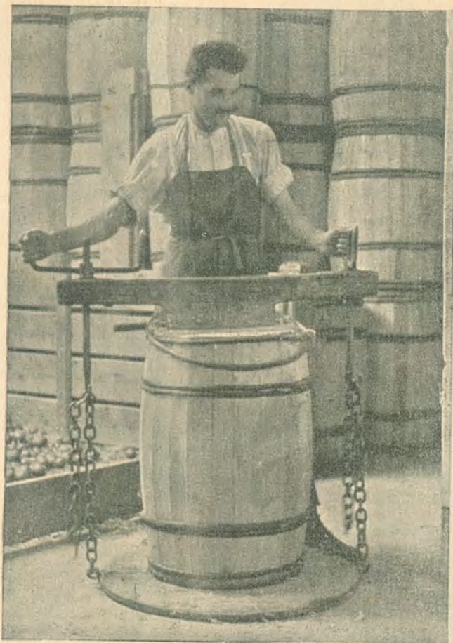
Obr. 155. Zavírání naplněných sudů tyrolským lisem.
