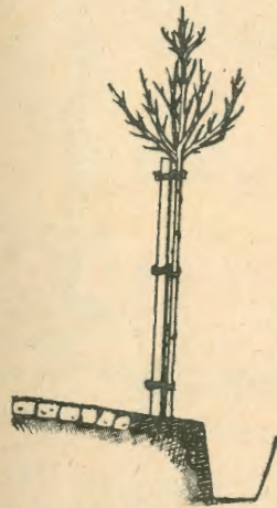
Obr. 38. Strom na silnici vysazený od krajnice asi 2 dm a chráněný kulem se strany silnice.
