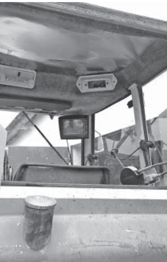
Auf dem Monitor im Trecker sind Personen, die sich im Gefahrenbereich befinden, zu sehen
