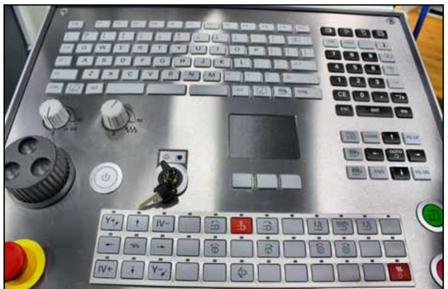
Das übersichtliche Tastenfeld verfügt über ein Touchpad. Wie in einer Textverarbeitung stehen die Funktionen Kopieren, Löschen und Einfügen zur Verfügung, sodass Programmabschnitte rasch umgestellt und ergänzt sind.
