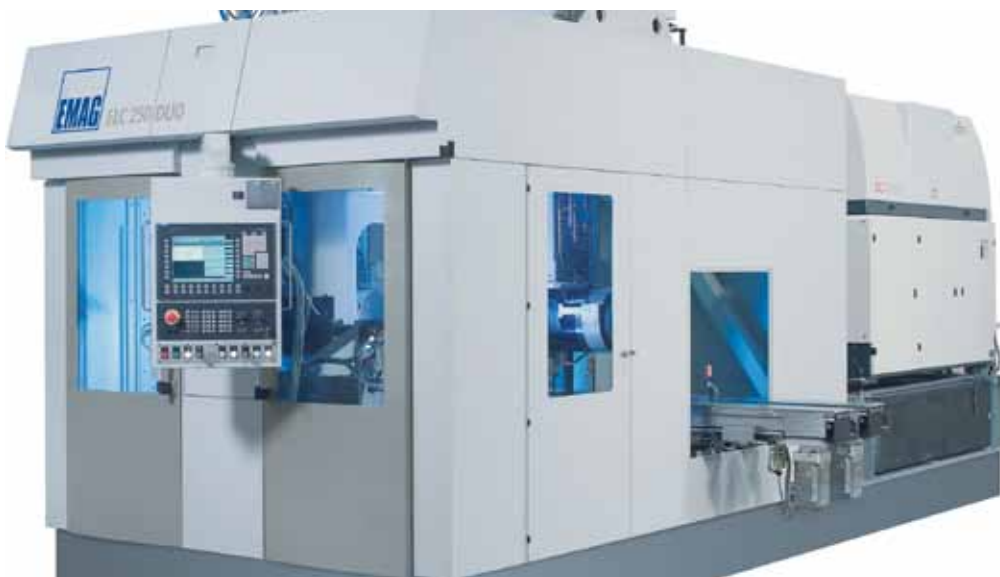
Die »ELC 250 DUO« ist eine kompakte Laserbearbeitungsmaschine für die Bearbeitung von Differentialgehäusen. Die als Duo-Variante konzipierte ELC ist doppelspindlig ausgeführt.
