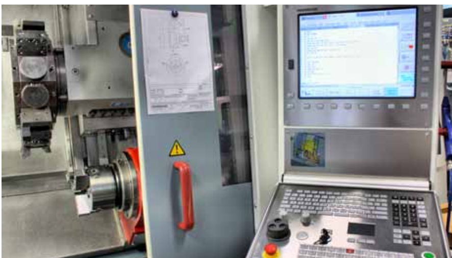
Mit der ›CNC Pilot 640‹ hat Heidenhain eine leistungsstarke Bahnsteuerung für Drehmaschinen im Portfolio, die die Rückseitenbearbeitung beherrscht und sogar über eine vollautomatische NC-Programmgenerierung verfügt.
