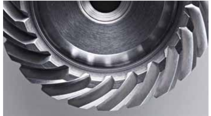
Auf einem Index Dreh-Fräszentrum ist die Komplettbearbeitung von Kegelrädern aus Stangenmaterial möglich.
