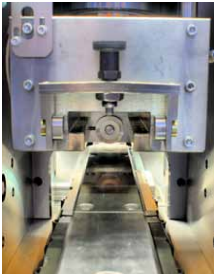
Eine ausgesprochen stabile Spanneinrichtung sorgt dafür, dass das Blech selbst im Fall höchster Prüfkraft sicher gehalten wird.
