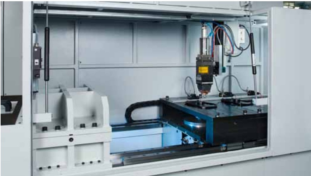
Arbeitsraum der Laserschweißmaschine ›ELC 160‹ für das Schweißen von Getrieberädern. An bis zu drei Stationen wird das Zahnrad erwärmt, gefügt und lasergeschweißt.
