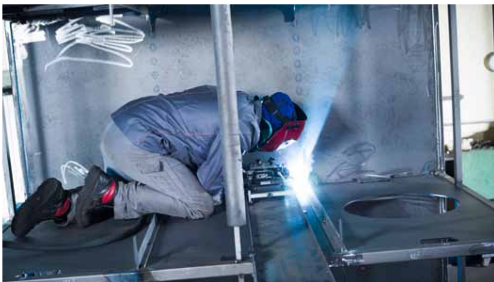
Bei der Fertigung der Wassertanks hat Mesa einen Teil der Fügeaufgaben mit einem pistengeführten Schweißtraktor mechanisiert. Dies trägt zu erheblichen Einsparung der Arbeitszeit bei.
