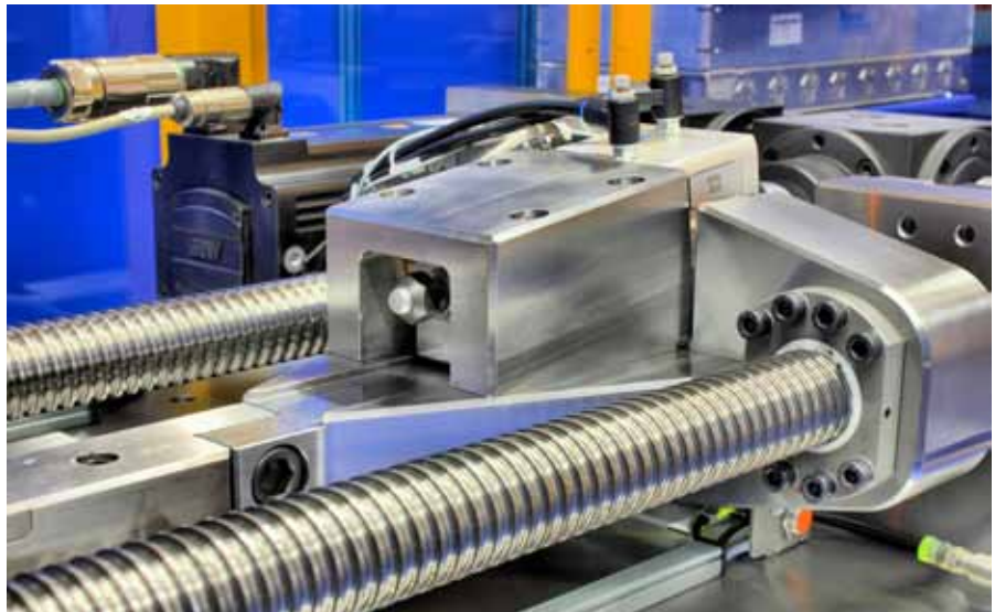
Die 3,5 Tonnen schwere Maschine ist kräftig dimensioniert, was problemlos Flächenpressungen von bis 2500 N/mm 2 erlaubt. Werkzeugeinsätze verschiedenster Geometrien und Materialien erlauben das Nachstellen unterschiedlicher Fälle, um das für den jeweiligen Zweck optimal formulierte Öl zu finden.
