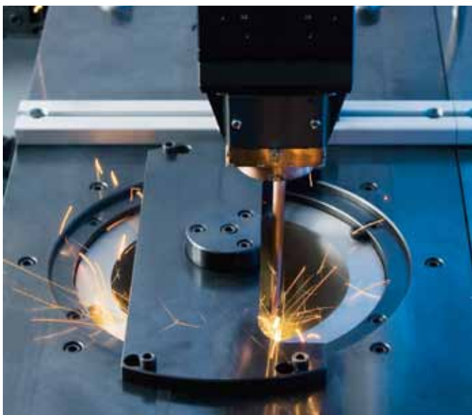
Laserschweißen eines Synchronrads auf ein Zahnrad. Halbierte Betriebskosten durch den neuen Faserlaser in der ›ELC 160‹.
