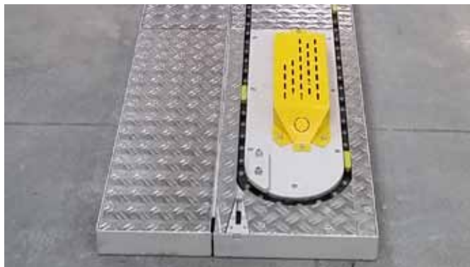
Das Kettenzugsystem ›TS-Z‹ von Knoll kann in einer Überflur-Installation oder bodeneben ausgeführt werden. Die nötige SPS-Steuerung ist in eine ERP-Landschaft einbindbar.
