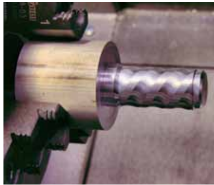
Selbst Polygonprofile und Exzenterteile lassen sich mit der CNC Pilot 640 ohne zusätzliche Spezialmechanik erstellen.
