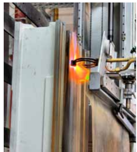
Via Flammhärten erhalten die Führungsbahnen der Betten die benötigte Härte.
