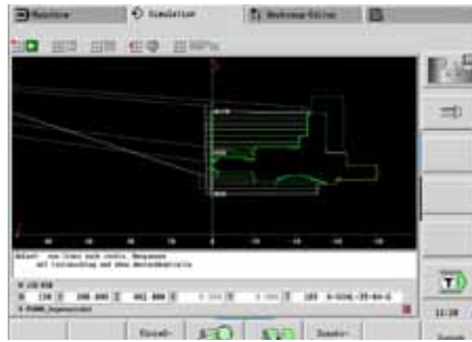
Eine Simulation der Rückseitenbearbeitung dokumentiert, ob das Teil korrekt zerspant wird.
