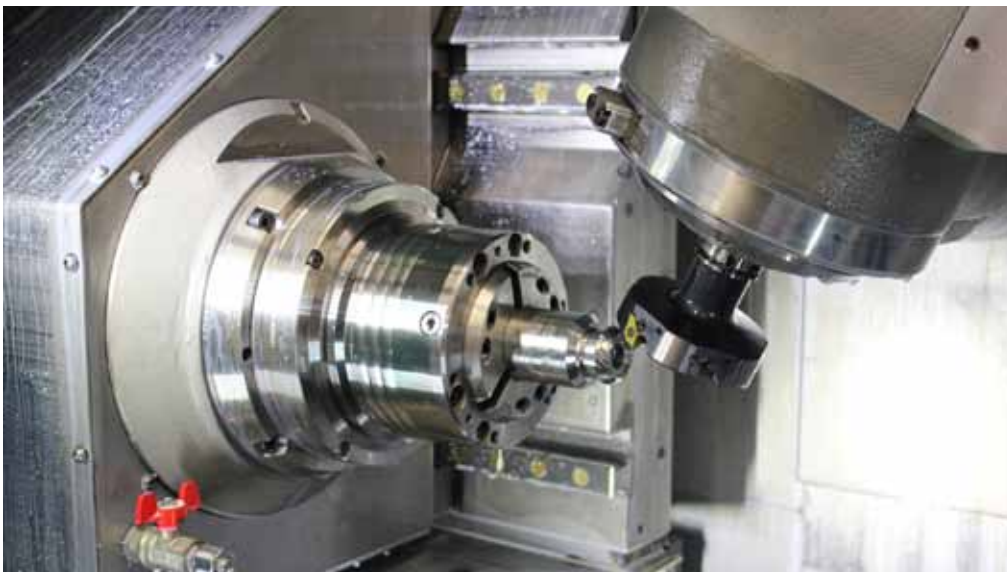
Via Technologiepaket werden die Dreh-Fräszentren Index R200/R300 zu Verzahnungsmaschinen. Der Steuerungszyklus bildet dabei die Kinematik einer Verzahnungsmaschine nach.
