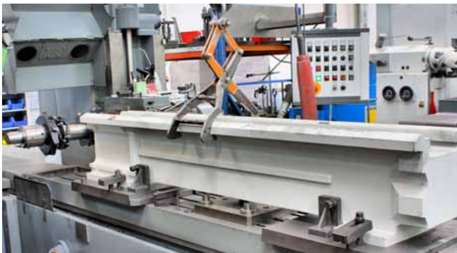
Die Maschinenbettführungen werden mittels eines Satzfräasers vorgefräst, anschließend gehärtet und schließlich per Profilschleifscheiben exakt auf Maß geschliffen.
