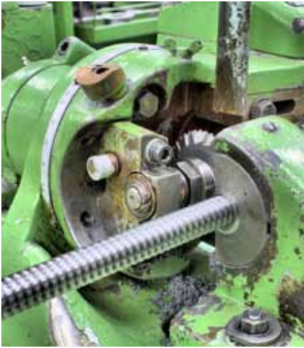
Beim Herstellen der Leitspindeln kommt das sogenannte ›Gewindefräsen‹ zum Einsatz, das höchste Präzision garantiert.
