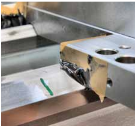
Beschichtete Maschinenführungen verhindern den gefürchteten Stick-Slip-Effekt und mindern zudem den Verschleiß.
