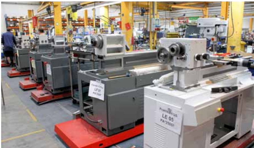
Mittels einer durchdachten Fließfertigung konnte die Durchlaufzeit von früher vier Wochen auf heute nur mehr zwei Wochen reduziert werden.
