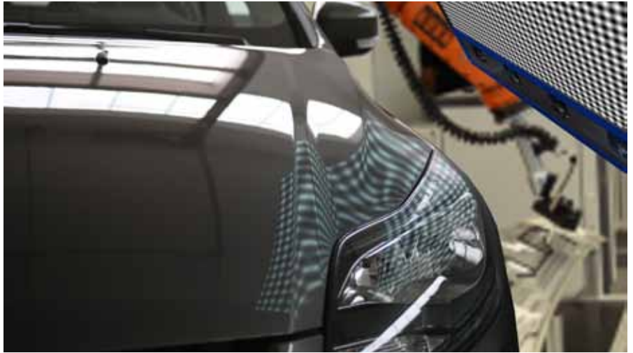
Einsatz der Single Shot-Technologie in der Fahrzeugproduktion: Produktionsfehler, die beim Glasbiegen oder beim Kunststoffspritzguss entstehen, werden sicher erkannt.
