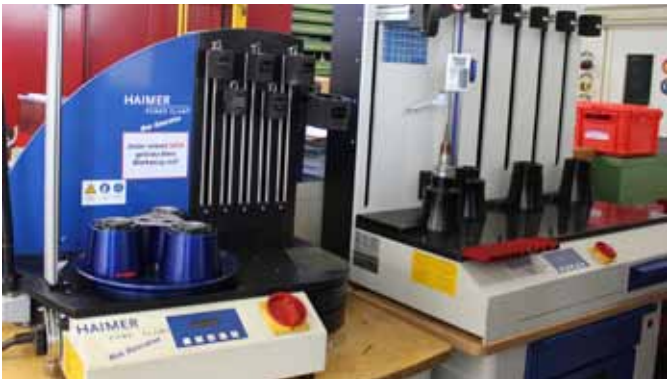
Zum Schrumpfen der Werkzeuge steht im Starrag-CPE ein Haimer Power Clamp NG (links) und ein Power Clamp Premium.
