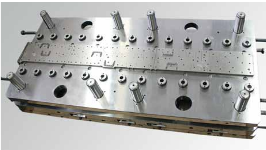
Mit der »ACC-208CH-iQ« werden ebene Platten aus Stahl mit und ohne Hartmetalleinsätzen geschliffen, die die Basiskomponenten der Stanzwerkzeuge darstellen.
