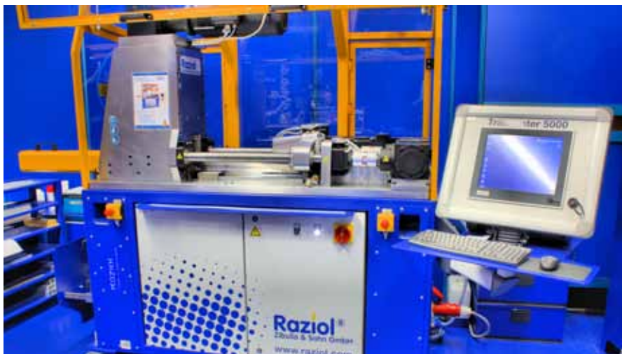
Das ›Tribometer 5000‹ von Raziol eignet sich bestens, um die optimale Abstimmung verschiedener Öle und Additive für einen ganz bestimmten Einsatzzweck zu finden.
