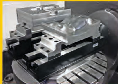
Mechanischer Zentrischspanner MZU auf Nullpunktspannsystem
