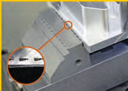
Mechanischer Zentrischspanner MZR – Wendeböcken mit Grip (1. Aufspannung) und glatter Spannstufe (2. Aufspannung)
