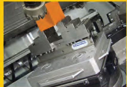
Mechanischer Zentrischspanner MZC auf Palettiersystem
