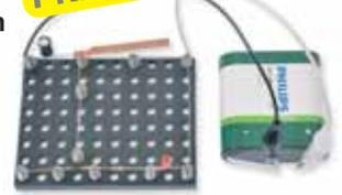
Mit dieser Werkpackung können 9 verschiedene Schaltungen aufgebaut werden, ideal zum grundlegenden Verständnis der Funktion der einzelnen Bauteile: Widerstand, Diode, Leuchtdiode, Transistor, Kondensator, Summer. Winkler Klemmsystem: Praktische Lochplatte mit Klemmfedern ermöglicht Auf- und Abbau ohne Werkzeug und ohne Löten. Inkl. umfangreichem achtseitigen Arbeitsblatt.
