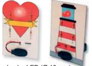
Eine rot blinkende Jumbo-LED (Ø 10 mm) bildet das Herzstück dieser beiden Lötübungen. Mit dem beiliegenden Material kann eine der beiden abgebildeten Schaltungen gebaut werden.
