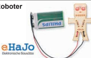
Dieser Bausatz entstand für die Make-Munich 2016 und ist perfekt für absolute Lötneinsteiger geeignet. Die LEDs und Widerstände werden auf einem vorgelagerten Sperrholzplättchen verlötet. Am Ende der Übung hat man einen kleinen Holz-Roboter mit leuchtenden Augen.
