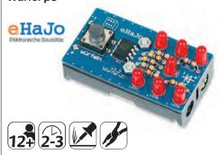
Elektronischer Würfelspaß. Der Mikrocontroller ist fertig vorprogrammiert. Der Würfel rollt auf Tastendruck los und bleibt nach ein paar Sekunden stehen. Bei Nichtnutzung geht die Schaltung in den Ruhemodus, um die Batterie zu schonen. Ein kurzer Druck auf die Taste zeigt die zuletzt gewürfelte Zahl an, ein längerer Druck würfelt erneut.
