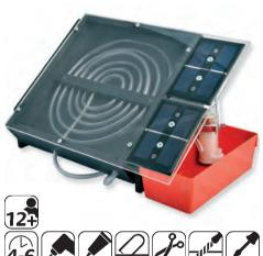
Mit dem absolut funktionstüchtigen Kollektor kann Wasser in ca. 1 Stunde auf mehr als 70 °C erhitzt werden. Die Kreiselpumpe wird von zwei leistungsstarken und wasserfesten Solarzellen, mit je 1 V/500 mA, angetrieben. Der Kollektor ist mit einer hochwertigen Plexiglasplatte abgedeckt. Der Wasserbehälter ist in der Werkpackung nicht enthalten.
