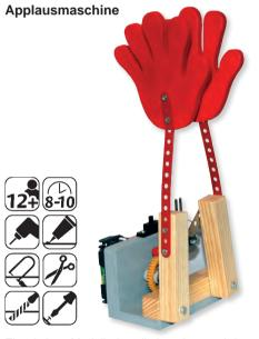
Ein witziges Modell, das alle begeistern wird. Die Mechanik dahinter ist einfach, aber effektiv: Ein E-Motor bewegt über ein Schneckengetriebe und eine Kurbel einen Metall-Lochstreifen in einer Führung auf und ab. An zwei weiteren Lochstreifen sind die Hände angebracht, die sich dann schlagkräftig berühren.
