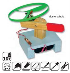
Eine tolle Idee. Ein kleiner Elektromotor auf einer verstellbaren Abschussrampe bringt den Propeller auf Touren. Sofort nach dem Loslassen des Tasters fliegt er etwa 10 m weit in die vorgegebene Richtung. Sehr einfacher Aufbau, bei dem die Schüler lernen, einen Stromkreis mit Batterie, Taster und E-Motor herzustellen.
