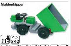
Kippfahrzeug aus Sperrholz mit gut funktionierender Achsschenkellenkung durch Verwendung von Zahnrad und Zahnstange.
