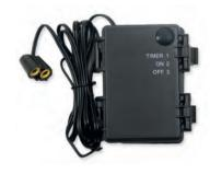
Praktische Batteriebox mit Schalter für wahlweise Dauerbetrieb oder 6 Stunden Timer, der sich nach Ablauf automatisch abschaltet. 1 Steckanschluss für Birnchen oder LED. Wird mit 3 Stk. Mignon AA Batterien befüllt und wie eine 4,5 V Flachbatterie betrieben.
