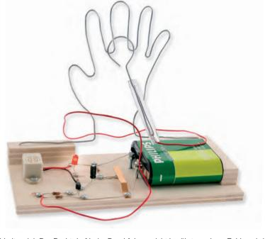
Beliebtes Geschicklichkeitsspiel: Der Draht darf beim Durchfahren nicht berührt werden - Fehler wird gespeichert und mittels Leuchtdiode und Summer angezeigt. Durch Quittieren mit dem Taster wird wieder weiter gespielt. Summer im Bausatz inbegriffen.
