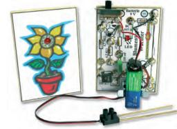
Die Reißzweckentechnologie eignet sich gut für die ersten Lötungen von elektronischen Schaltungen: Die Köpfe der Messingreißnägel/Reißzwecken dienen als großzügige Lötstützpunkte. Praktische Schaltung, die den Feuchtegrad der Erde überwacht. Bei Wassermangel beginnt eine Leuchtdiode zu blinken. Empfindlichkeit einstellbar. Sehr batterieschonend durch wenige, passive Bauteile.
