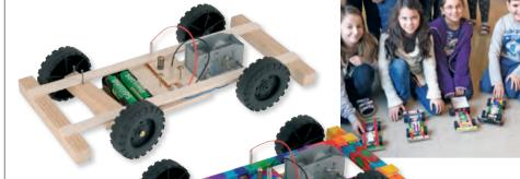
Dieses tolle Elektrofahrzeug wechselt automatisch die Fahrtrichtung, wenn es gegen ein Hindernis fährt. Der Motorumpoler wird auf einfachste Weise selbst hergestellt. Ein Werkstück, bei dem die Kinder sehr viel lernen. Bei der Gestaltung der Karosserie haben die Kinder freie Hand. Eine spannende Rallye im Klassenzimmer ist sicher! Welches Fahrzeug bleibt am längsten im Rennen?
