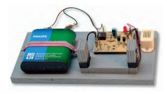
Wird der unsichtbare Infrarot-Lichtstrahl unterbrochen, dann ertönt vom Summer ein lautes Alarmsignal. Das Herzstück dieses Modells bildet eine PRINT-Lichtschranke, die zusammen mit den anderen Komponenten übersichtlich auf einem Brett montiert wird. Komplettbausatz inkl. Platine, Elektronikteile und Summer.
