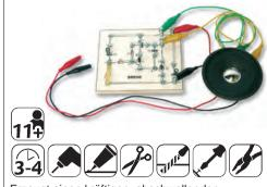
Erzeugt einen kräftigen, abschwellenden Sirenenton. Durch das schnelle Laden und Entladen eines Kondensators entstehen Schwingungen, die durch einen Lautsprecher hörbar werden. Inkl. Arbeitsblatt und Lautsprecher. Werkpackung mit Elektronikteilen, Brettaufbau und Messstrippen.
