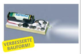
Einfach aufzubauende Taschenlampe, die auch für Lötanfänger geeignet ist. Mit der Sparschaltung holt man den letzten Rest aus einer eigentlich schon leeren 1,5 V Batterie und betreibt damit eine superhelle, weiße LED, die normalerweise mind. 3,2 V benötigt. Ein Wunder? - Nein, ein IC wirkt als DC-Spannungswandler, der die benötigte Spannung liefert.
