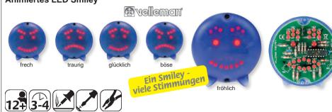
Anspruchsvollere Lötarbeit mit 26 LEDs. Das Smiley kann jede Stimmungslage anzeigen. Per Druckknopf kann zwischen bewegten oder festen Ausdrücken gewählt werden. Lieferung inkl. Gehäuse, automatische Abschaltung. Inkl. leicht verständlicher, auf Symbolen basierender, Arbeitsanleitung. TIPP: 3 Stk. Micro Batterien 1,5 V (Art. Nr. 100310) mitbestellen.
