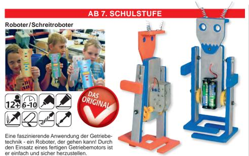
TIPP: Als Augen können Leuchtdioden (mit Vorwiderstand für 3 V) eingebaut werden.
