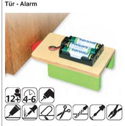
Der Tür - Alarm wird einfach vor eine Tür gestellt. Sobald jemand die Tür öffnet, wird ein markanter Alarmton ausgelöst, der den Eindringling vertreiben soll. Das Herzstück des Türalarms ist ein PRINT-Zeitschalter, der durch den beiliegenden Mikro-Hebelschalter aktiviert wird. Die Dauer des Alarmtones kann mit einem Drehwiderstand stufenlos eingestellt werden. Schülergerechte funktionssichere Bauform.
