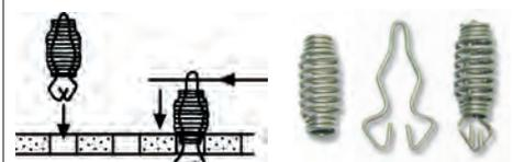
Klemmfedern für das Winkler Klemmsystem: Auf- und Abbau von Elektronik-Schaltungen ohne Werkzeug und ohne Löten. Einfach und kontaktsicher, verzinnter Federstahldraht. Die 2-teiligen Klemmfedern können einfach von oben in die Lochplatte eingesetzt werden, ohne diese auseinander zu nehmen.
