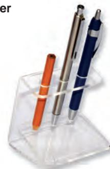
Fertigung aus einem klaren Plexiglasstreifen (230x70x3 mm) durch Bohren und Biegen. Thermo-Biegegerät erforderlich!
