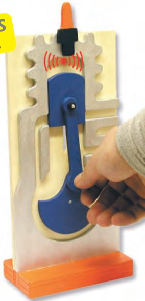
Das anschauliche und lehrplangerechte Funktionsmodell wird aus Sperrholz gefertigt. Eine eingebaute Leuchtdiode zeigt, gesteuert von der rückseitigen Zündanlage, den Zündzeitpunkt an. Durch den Aufbau und die detaillierte Anleitung erlangen die Schüler die wichtigsten Grundkenntnisse über die Teile und Funktionsweise des Zweitaktmotors.
