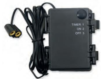
Praktische Batteriebox mit Schalter für wahlweise Dauerbetrieb oder 6 Stunden Timer, der sich nach Ablauf automatisch abschaltet. 1 Steckanschluss für Birnchen oder LED. Wird mit 3 Stk. Mignon AA Batterien befüllt und wie eine 4,5 V Flachbatterie betrieben.
