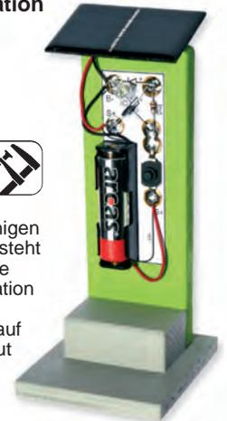
Aus Sperrholz und wenigen Elektronikbauteilen entsteht eine voll funktionsfähige und praktische Ladestation für Mignon-Akkus. Der Aufbau der Schaltung auf Reißzwecken ist absolut unkompliziert und schülergerecht. Neben der IC-gesteuerten Ladefunktion hat die Station zusätzlich eine weiße LED, die bei Dunkelheit automatisch zu leuchten beginnt. Werkpackung inkl. Akku und Solarzelle.
