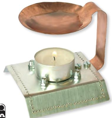
Die einfache, dekorative Duftlampe aus Kupfer- und Alublech eignet sich sehr gut als Einführungsarbeit in die Metallbearbeitung. Nach dem Anreißen und Bohren kann die Alu-Grundplatte punziert, d.h. mittels Körner mit punktförmigen Mustern versehen werden. Die Schale entsteht durch Treiben mit einem Treibhammer und Treibklotz. Die Blechteile können wahlweise verschraubt oder genietet werden. Werkpackung inkl. Schrauben, Nieten und Teelicht, jedoch ohne Duftöl.
