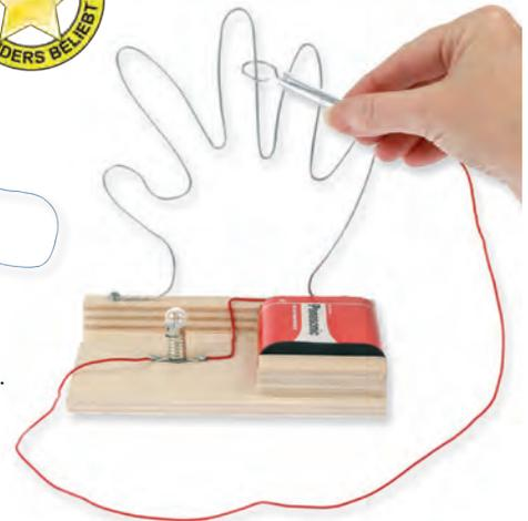
Geschicklichkeitsspiel: Das Handstück muss entlang der Rennstrecke geführt werden, ohne diese zu berühren. Ohne Löten herstellbar. Um ein akustisches Signal zu erhalten, kann zum Lämpchen ein Minisummer angeschlossen werden.
