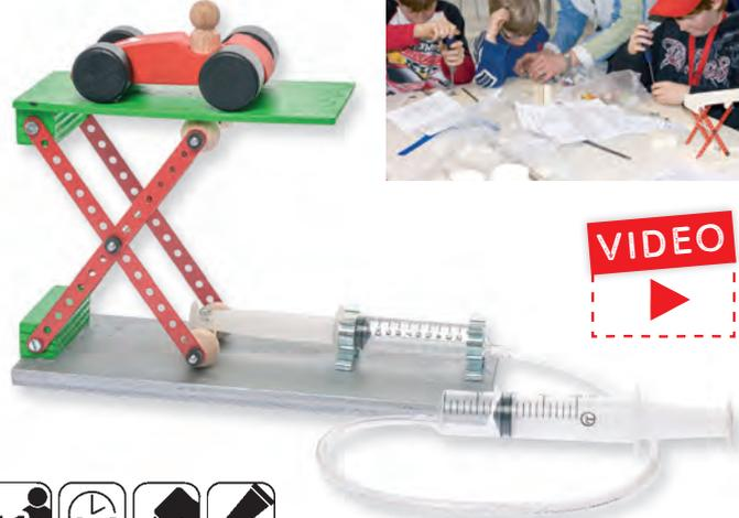
Der Scherenmechanismus dieser kräftigen Hebebühne wird durch 2 Spritzen (10 ml + 20 ml) auf und ab bewegt. Eine einfache aber eindrucksvolle Arbeit als Einstieg in das Thema Pneumatik und Hydraulik.
