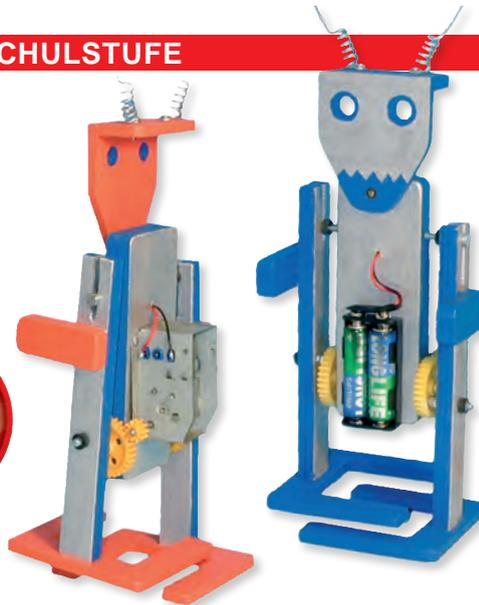
Eine faszinierende Anwendung der Getriebetechnik - ein Roboter, der gehen kann! Durch den Einsatz eines fertigen Getriebemotors ist er einfach und sicher herzustellen.
