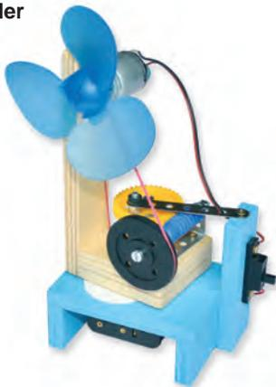
Der Aufbau des Ventilators schwenkt durch das Schneckengetriebe um 90° hin und her. Die schlagfeste Luftschaube wird über einen Riemen angetrieben. Schülergerechte und funktionssichere Bauform mit sehr guter Luftleistung.
