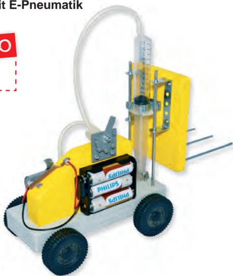
Eine tolle Erweiterung unseres bewährten PH-Hubstaplers, der nun elektropneumatisch angesteuert wird. Das Herzstück ist ein leistungsstarker E-Kompressor mit Saug- und Druckfunktion, der über ein Steuerventil den Arbeitszylinder (Spritze) hebt und senkt. Einfacher Aufbau und sicheres Gelingen dank fertiger Metallführungen. Die Schüler erlernen die Grundfunktionen von Hydraulik/Pneumatik und das Herstellen eines einfachen Stromkreises.
