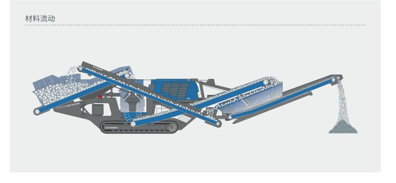
得益于紧凑的外形和快速的设置,该移动圆锥式破碎设备十分灵活且易于运输。它用途广泛,并可快速准备就绪。装备"释铁"或"跳锥检测"等智能、有效的过载保护系统,即使在困难工况下,也可确保安全、稳定的施工,并获得品质优异的成品。
