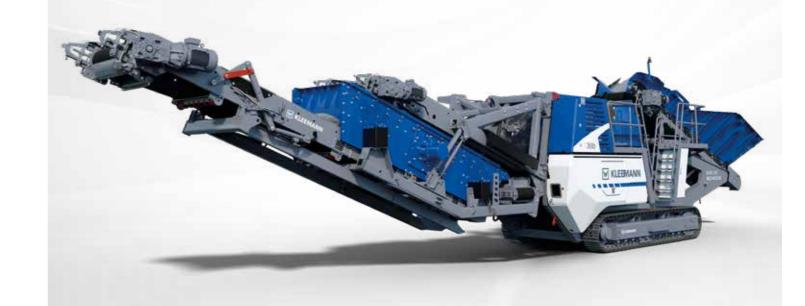
履带底盘移动圆锥式破碎设备
