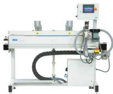
**RKS RAKELSCHLEIFAUTOMATEN TYP SM**
