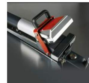
Der progressive Klemmdruck und die Hebefunktion des SEFAR® 3A Spannsystems erhöht die Kapazität und vermindert Geweberisse im Spannprozess. Weshalb? Das Gewebe kann nicht aus den Klemmböcken rutschen und die Reibung zwischen Gewebe und Siebdruckrahmen wird eliminiert. Damit produzieren Sie täglich fehlerlose, gleichmäßig gespannte Siebe. Als weiterer Pluspunkt: Unabhängig von der Rahmengröße, dem Garnmaterial oder der Gewebefeinheit eignen sich SEFAR® 3A Spannklemmen für alle Siebdruckgewebe.
