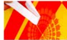
Der Hafttest beweist es: sehr gute Haftung des Schablonenmaterials, feste Verankerung feiner Rasterpunkte und Linien
