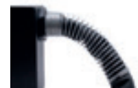
kontrollierter Biegeradius an der Schweißmaschine
