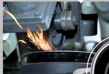
Der Schüttrand wird geschliffen und im galvano-technischen Verfahren aufgebracht.
