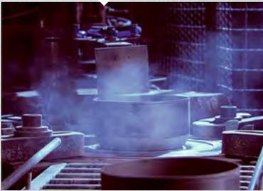
Der Stahlkern wird im Streckzugverfahren auf Ziehpressen gezogen.
