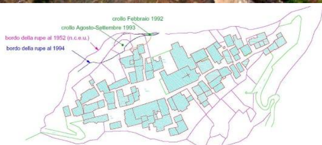
Figura 7. Frane recenti e situazione attuale
