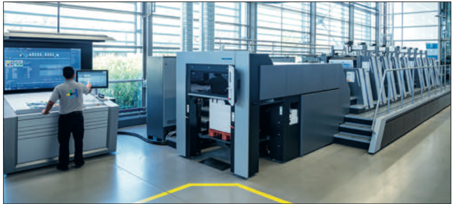
Die komplett neu überarbeitete Prinect Press Center Generation mit dem neuen Speedmaster Operating System bringt Push to Stop-Funktionalität und die Prinect Cloudschnittstelle an jede Speedmaster.
