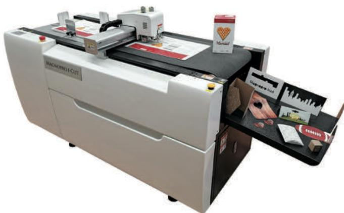
**Individuelle Stanzungen, Rillungen, Perforationen, V-Schnitt, Anschnitt: Die Magnopro i-Cut Digitalstanze ist perfekt geeignet für alle anfallenden Arbeiten.**
