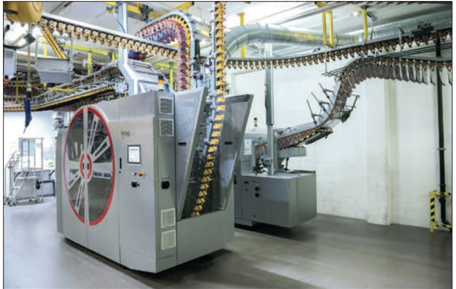
**Die Hefttrommel StreamStitch und die Schneidtrommel SNT machen nun auch eine Produktion von Coldset-Produkten bei der vollen Geschwindigkeit von 36.000 Takten/h mit separatem Umschlag oder aus unterschiedlichen Substraten möglich.**
