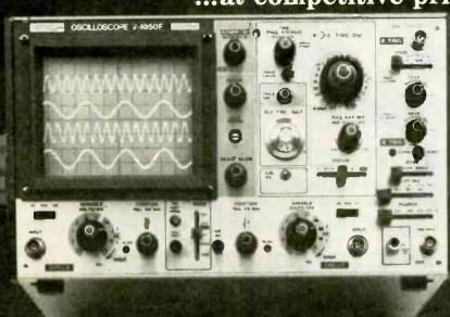
Hitachi **V-1050F** 100MHz, QUAD TRACE DELAYED SWEEP
