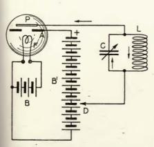
FIGURE 98—Dynatron oscillator.
