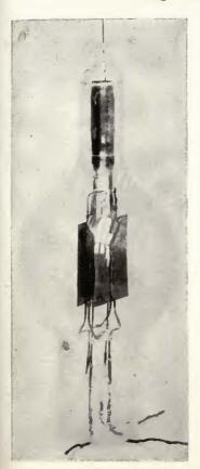
FIGURE 92—General Electric Company pliotron.
