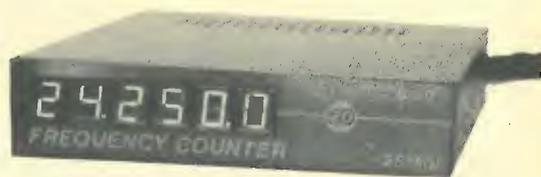
Oltre che come normale frequenzimetro, si può usare abbinato a qualsiasi RICEVITORE-TRASMETTITORE per leggere direttamente la frequenza di ricezione e di trasmissione (adatto anche per SSB). Somma o sottrae alla frequenza di ingresso qualsiasi valore compreso tra zero e 99.999,9 (con prescaler da zero a 999.999).
