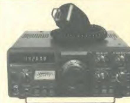
**TRANSCEIVER HF 10 ÷ 80 m** - USB - LSB - CW - Potenza 20 W RF P.e.P. - Alimentazione 13,8 V DC - ASS. 3 A. - RIT pas band vox (forniti).
