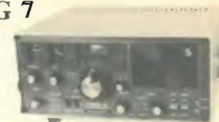
Ricevitore copertura continua da 0,5 a 30 MHz con sintonia fine, alimentazione entrocontenuta od esterna sia a 12 che 220 V prezzo informativo **L. 352.000**
