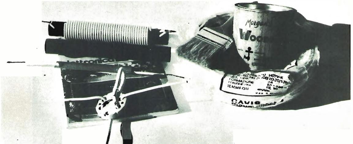
Da notare l'isolatore in ceramica; come vanno ancorati i due bracci del dipolo; come va collegato il cavo da 75  $\Omega$ .
