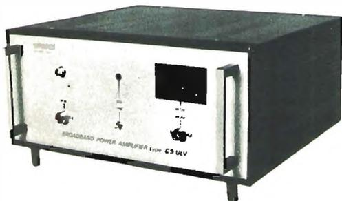
Apparati modulari formati da amplificatori a larga banda e da accoppiatori ibridi in grado di coprire l'intera banda Tv senza necessità di accordi o taratura.
