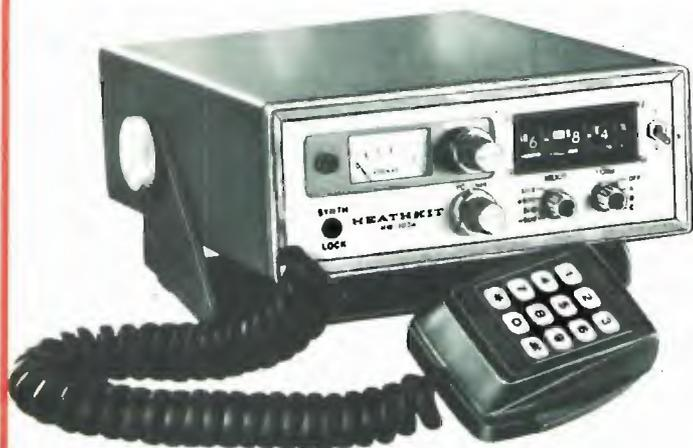
Rice-trasmettitore FM sintetizzato, con copertura di frequenza da 143,5 a 148,5 MHz.
