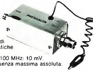
Utile per aumentare la sensibilità e la frequenza di utilizzo di frequenzimetri con scarse caratteristiche d'ingresso. Alimentazione: 5 Vc.c. Assorbimento: 75 mA. Sensibilità a 100 MHz: 10 mV. Sensibilità a 600 MHz: 50 mV. Frequenza massima assoluta: 600 MHz. Rapporto di divisione: 10
