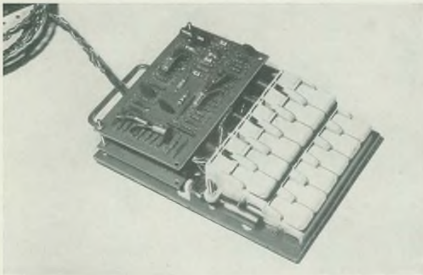
Bild 2: Ansicht des Zusatzgerätes mit den beiden übereinanderliegenden Platinen und den Druckschaltern für die Punkt- bzw. Strichfolgen
