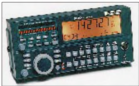
Bedienteil des DSP-Transceivers SG-2000 PT von SGC
