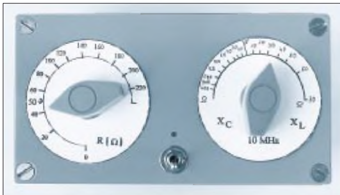
Bild 6: Frontansicht des Geräts. Links die Skale für den ohmschen Anteil, rechts für den Blindanteil, in der Mitte unten der Schalter für die Betriebsspannung
