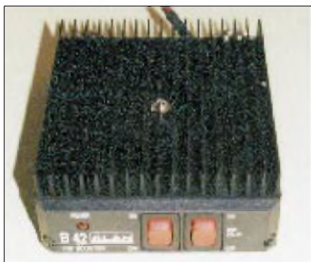
Preisgünstige 2-m-Linearendstufe, die Multimode-Transceiver von 10 W auf 40 W bringt, von Alan
