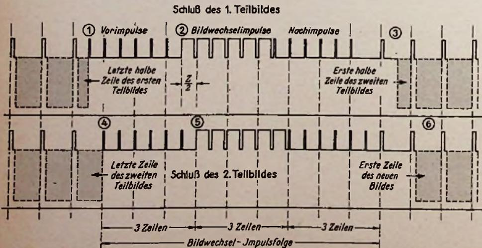
Bild 7. Gleichlaufzeichen für die Vertikalablenkung der beiden Teilbilder
