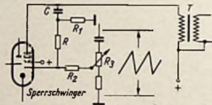
Bild 109. Frequenzabhängige Gegenkopplung nach Philips
