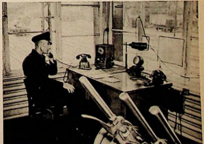
Rangier-Verkehr durch UKW gesteuert. Vom Stellwerk eines Industrie-Bahnhofs im Kohlenpott werden die Rangierloks durch UKW gelenkt (Werkfotos Telefunken)
