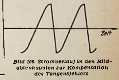
Bild 106. Stromverlauf in den Bildablenkspulen zur Kompensation des Tangensfehlers
