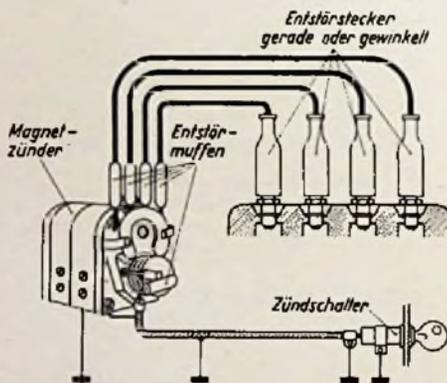
Bild 5. Behelfsmäßige Entstörung einer Magnet-Zündanlage
