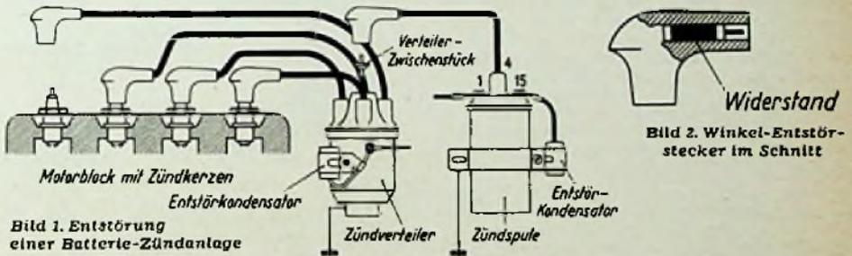
Bild 1. Entstörung einer Batterie-Zündanlage
