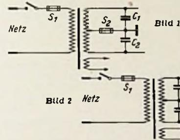
den kurzgeschlossenen Kondensator  $C_1$  die doppelte Spannung als ursprünglich vorgesehen an  $C_2$ . Er wird in kurzer Zeit ebenfalls durchschlagen und damit die gesamte Anodenwicklung kurzschließen. Die Schutzmaßnahme wirkt sich also gerade gegenteilig aus und führt zur Beschädigung eines weiteren Einzelteiles. Die Primärwicklung ist nun meist im Vertrauen auf die Sekundärsicherung zu hoch bemessen und spricht erst an, wenn der Netztransformator durchgebrannt ist.
