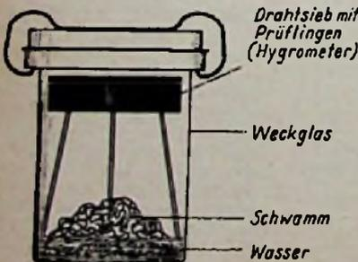
Bild 1. Weckglas als Feuchtraum zur Kondensatorprüfung
