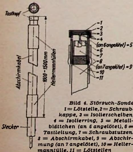
Bild 4. Störsuch-Sonde
