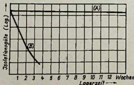
Bild 2. Isolationsgüte von Kondensatoren bei Lagerung im Feuchtraum nach Bild 1. A = zeitlicher Tauchkondensator (Wima-Tropydur), B = Kondensator der Klasse 3 in Preßstoff- oder Hartpapierrohr, der durch Feuchtigkeit gelitten hat. (Nach Messungen der Fa. Wilhelm Westermann, Unna/Westf.)
