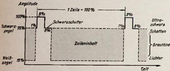
Bild 6. Deutsche Fernsehnorm für Bildinhalt und Gleichlaufzeichen einer Zeile
