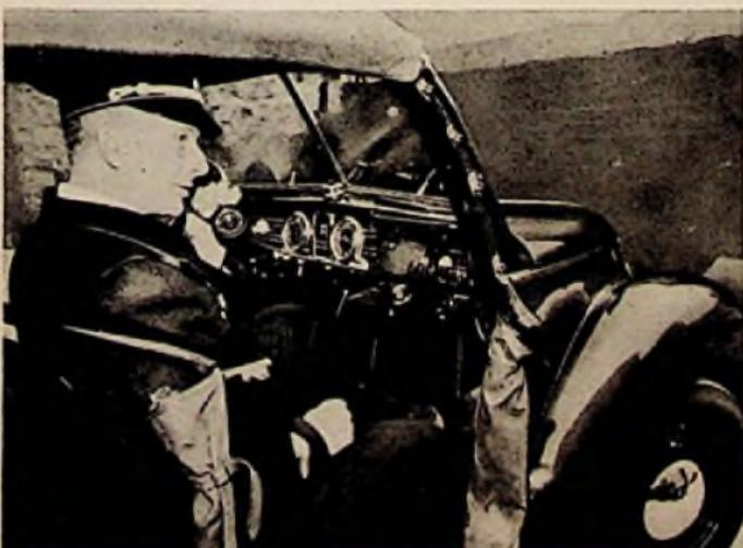
Polizistfunk auf UKW. Der Kommandeur des Funkstreifen dienstes empfängt und sendet vom Wagen aus. Das Bedienungsgerät ist im Handschuhkasten
