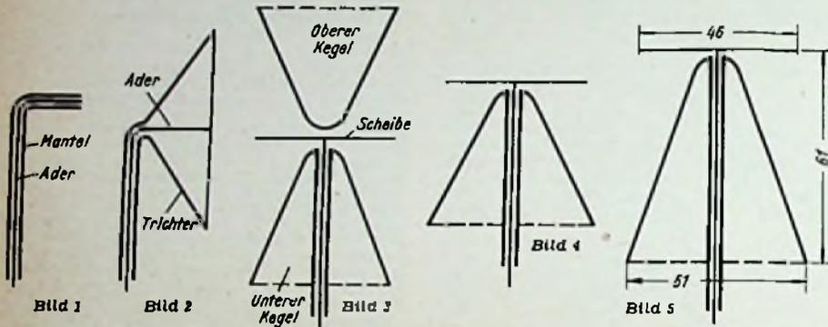
Bild 1. Rechtwinklig abgelenktes Koaxialkabel. — Bild 2. Kabelmantel zum Trichter erweitert. — Bild 3. Trichter und Kabelader rotierend gedacht, ergeben eine Scheibe mit zwei Kegeln (schematisch im Schnitt dargestellt). — Bild 4. Durch Weglassen des oberen Kegels entsteht die Discone-Rundstrahl-Antenne. — Bild 5. Abmessungen einer Discone-Antenne für UKW-Rundfunk und Fernsehen (Maße in Zentimetern)
