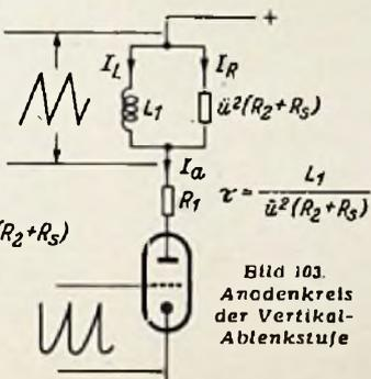
Bild 103. Anodenkreis der Vertikalablenkstufe
