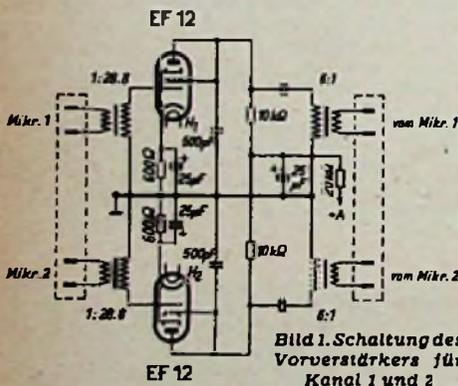
Bild 1. Schaltung des Vorverstärkers für Kanal 1 und 2
