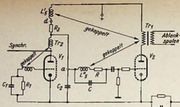
Bild 107. Vertikal-Ablenkschaltung nach Telefunken
