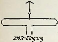
Anschluß der Hochantenne an den Zimmer-Dipol
