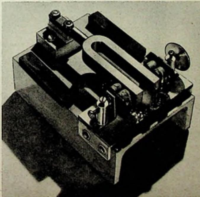
Bild 2. Ansicht eines 1000-Hz-Stimmgabelfrequenznormals. Zu beiden Seiten der Stimmgabel sieht man die einstellbaren Erregerspulen, aus je zwei Kopfhörersystemen bestehend. (Aufnahme: Carl Stumpf)
