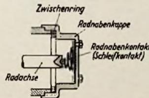
Bild 10. Reifenentstörung durch Radnabenkontakte
