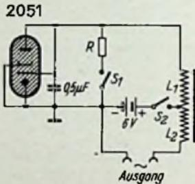
Einfache batteriegespeiste Thyatronschaltung zur Erzeugung hoher Wechselspannungen
