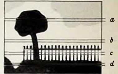
Bild 8. Beispiel eines zu übertragenden Bildes mit verschiedenen Bildeinheiten
